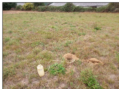
◀ Schéma de principe d'une noue d'infiltration - Réalisation d'un essai Porchet
