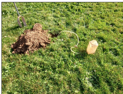
◀ Réalisation d'un test de perméabilité de type Porchet
